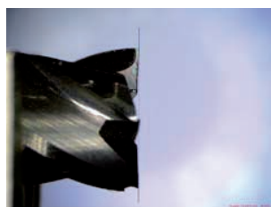
Ángulo de inclinación del borde
