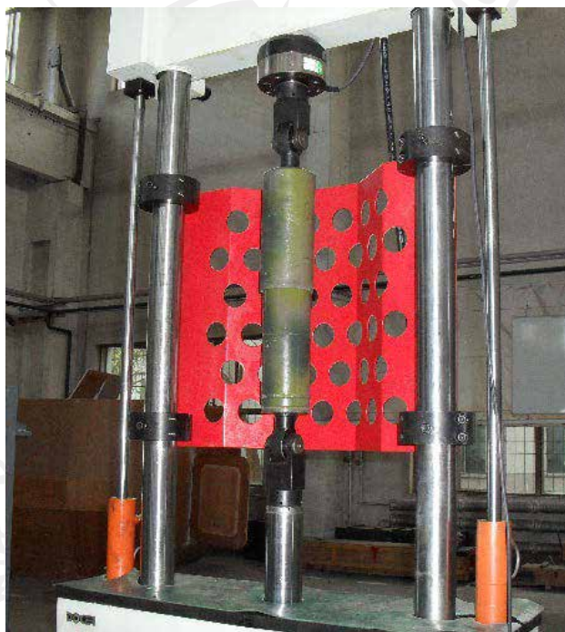
Ensayo de fatiga de amortiguadores
