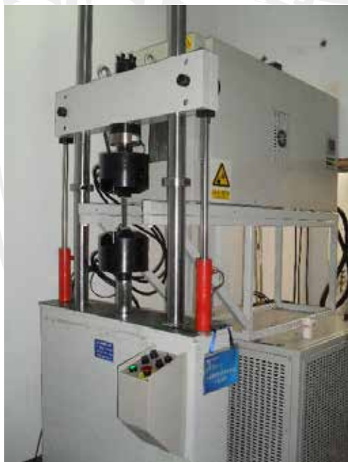
Con cámara de alta-baja temperatura
