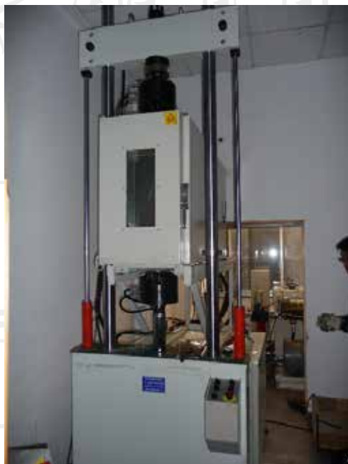
Con cámara de alta-baja temperatura
